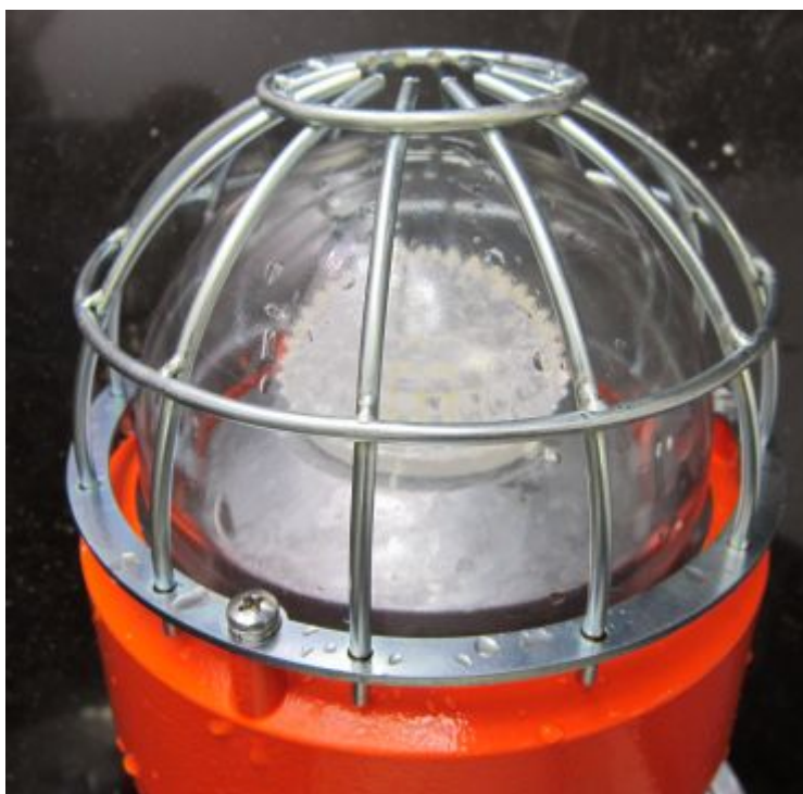
Рисунок 1. Выходное окно светильника после всех типов воздействий по ГОСТ IEC 60598-1-2013. Проникновение влаги внутрь оболочки присутствует, работоспособность сохранена.
